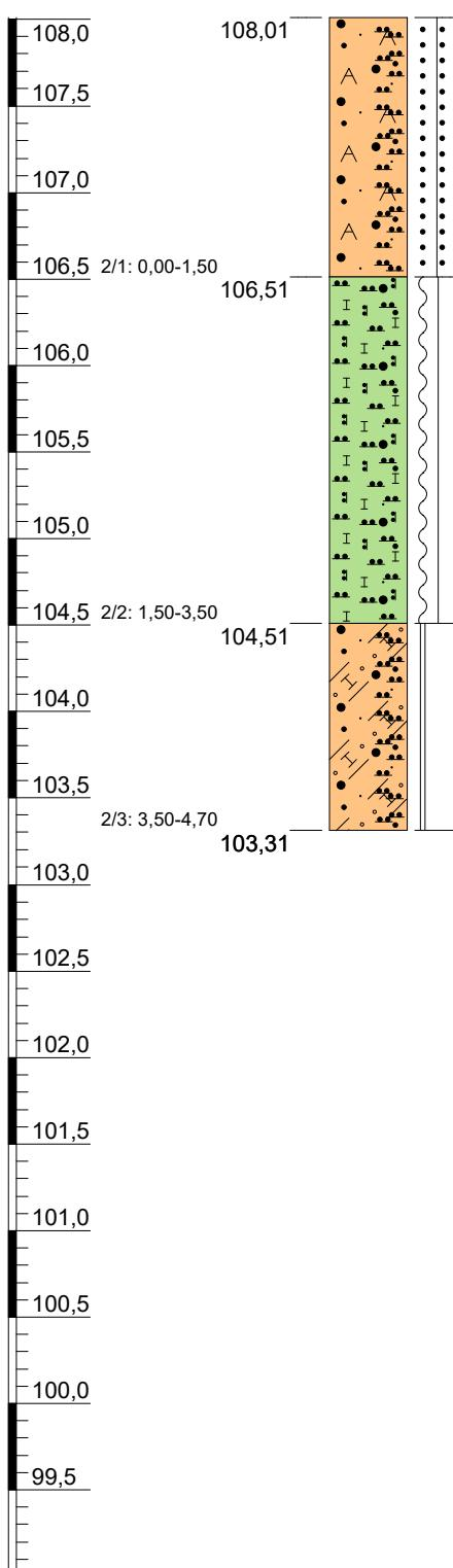
0,00 - 1,50 m, Sand (stark schluffig, schwach kiesig, Ziegelreste), Auffüllung, dunkelbraun, braun, beige, erdfeucht, locker gelagert bis dicht gelagert
