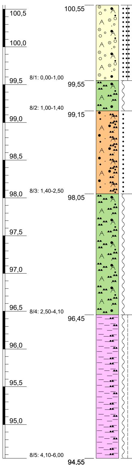
0,00 - 1,00 m, Kies (sandig, schwach schluffig, kohlehaltig), Auffüllung, grau, schwarz, erdfeucht, locker gelagert bis sehr dicht gelagert, Gleisschotter
