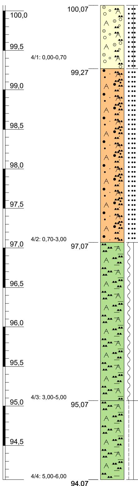
0,00 - 0,80 m, Kies (schluffig, sandig, durchwurzelt, kohlehaltig), Auffüllung, schwarz, dunkelbraun, erdfeucht, locker gelagert bis sehr dicht gelagert
