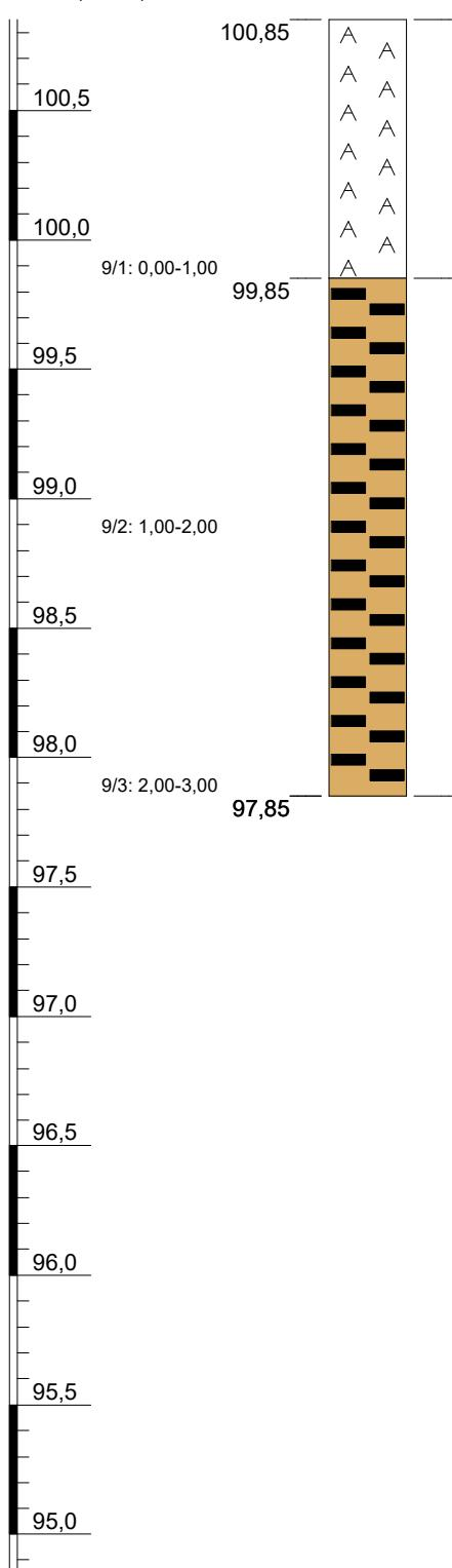
0,00 - 1,00 m, Bauschutt, Beton, Ziegelreste,
