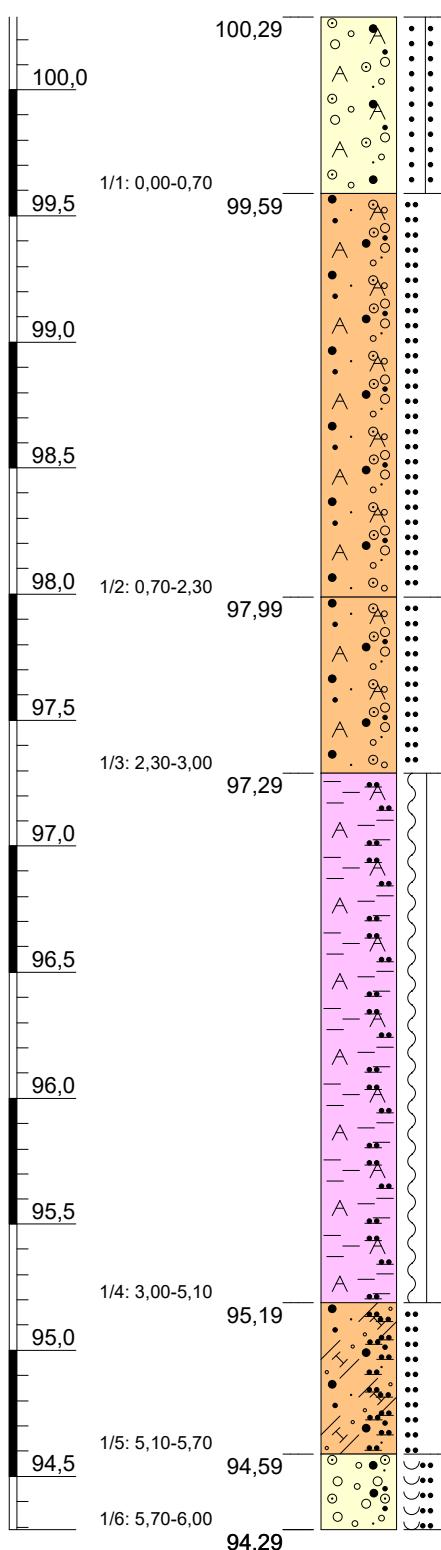
0,00 - 0,70 m, Kies (sandig, schwach schluffig), Auffüllung, dunkelbraun, grau, erdfreucht, locker gelagert bis dicht gelagert, Gleisschotter
