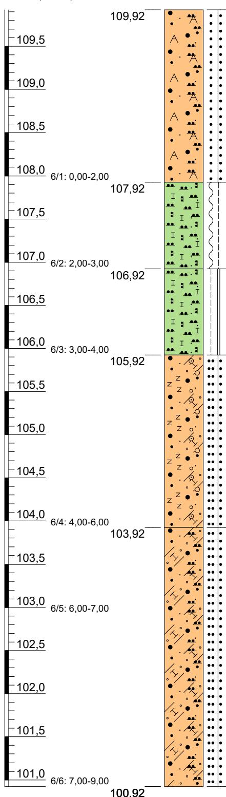
0,00 - 2,00 m, Sand (schluffig, kiesig, Bauschutt), Auffüllung, braun, erdfeucht, locker gelagert bis dicht gelagert
