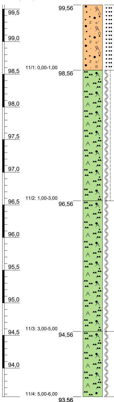
0,00 - 1,00 m, Sand (kiesig, schwach schluffig, Bauschutt, Beton, Sandstein), Auffüllung, bunt, grau, trocken bis erdfeucht, locker gelagert bis mitteldicht gelagert
